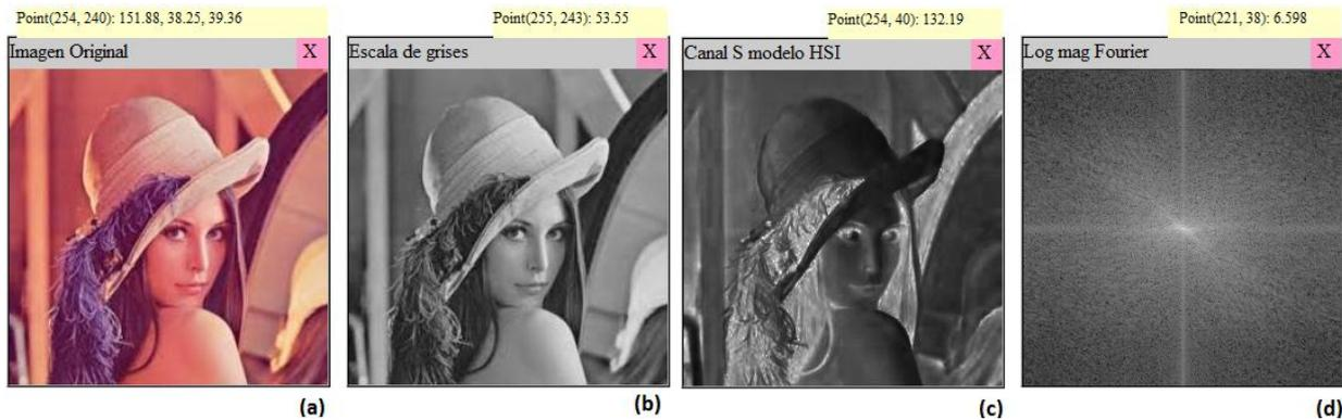
Figura 2: (a): Imagen Original (b): Escala de grises. (c) Canal S modelo HSI. (d): Logaritmo magnitud del Espectro de Fourier
