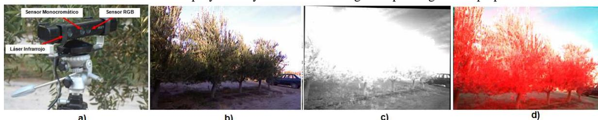
Figura 1. a) Cámara Kinect. b) Imagen RGB. c) Imagen IR. d) Imagen Pseudo-coloreada.
